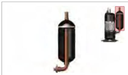
El deshecho de aceite y el espesor de la capa de aceite se han mejorado mediante la reducción de pérdidas de succión y el mejoramiento de la recolección de aceite a través de la optimización de la ruta de succión
